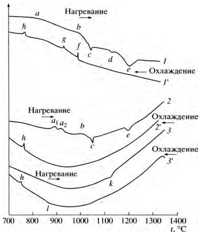
Рис. 5. Кривые нагревания и охлаждения образцов 0.97\text{ZrO}_2 \cdot 0.03\text{Y}_2\text{O}_3 , легированных 3 мол. % \text{CuO} [23]: 1, 1' – кривые единичного нагревания и охлаждения; 2, 2' – кривые нагревания с изотермической выдержкой при 1350°C в течение 1 ч и охлаждения; 3, 3' – кривые повторного нагревания и охлаждения соответственно (кривые 1, 1' получены на приборе Model S10DSC, а 2, 2', 3, 3' – на приборе SDT 2960 со скоростью нагрева 10°C/мин, охлаждения 5°C/мин; кривые 1, 1' и 2, 2', 3, 3' проведены на двух различных образцах).
